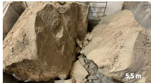
MYND 4.5 Sýnin sem tekin voru úr könnunargryfju EGC-42 (á svæði D-Tjaldsvæði) eftir þurrkun, frá 0,5-5,5 m dýpi.
