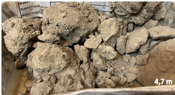
MYND 4.5 Sýnin sem tekin voru úr könnunargryfju EGC-42 (á svæði D-Tjaldsvæði) eftir þurrkun, frá 0,5-5,5 m dýpi.
